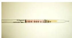
北川式ガス検知管 測定範囲:0.05～4.0ppm
